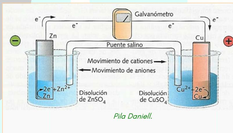
Entre los dos electrodos se genera una diferencia de potencial que se puede medir con un voltímetro.
